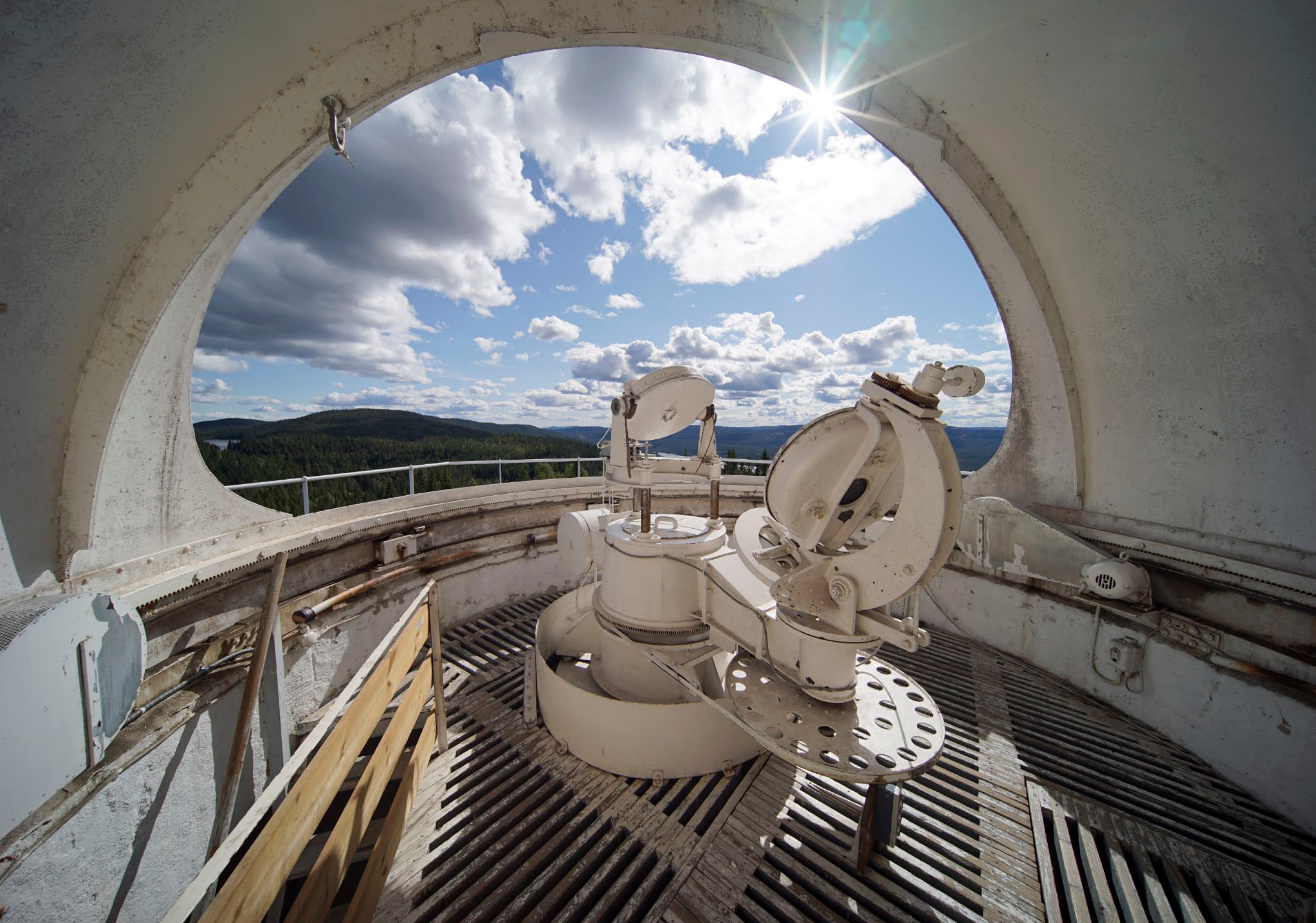
SPEILTELESKOPET / Når speilene er riktig vinklet, ledes sollyset ned i tårnet og inn i spektrografen
